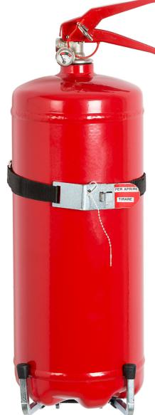
Supporto Universale porta estintore a parete, realizzato in metallo con due fori D. 7 mm per fissaggio a parete - Zincato. Regolabile per estintori con serbatoio da diametro 100 a 200 mm. Con sistema di apertura antipanico e sigillo di controllo.
